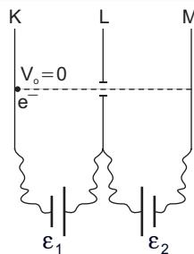
Şekildeki K levhasından serbest bırakılan elektron yatay sürünmesiz düzlemede hareket ederek L levhasından ve  $3v$  hızıyla geçip M levhasına  $v$  hızıyla çarpıyor.
