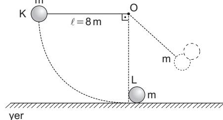
Uzunluğu 8 metre olan ipin ucundaki  $m$  kütleli K cismi şekildeki gibi serbest bırakılıyor ve durmakta olan  $L$  ye çarparak ona yapışıyor.
