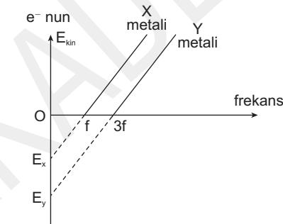
X ve Y metallerine gönderilen 4f frekanslı fotonların X metalinden kopardıkları elektronların kinetik enerjisi  $E_1$ , Y metalinden kopardıkları elektronların kinetik enerjisi  $E_2$  oluyor.
